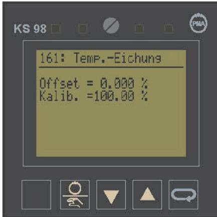
Der KS 98 lässt sich ohne Programmierkenntnisse mit drei Tasten leicht und übersichtlich auf die probenspezifischen Parameter (Temperatur-Zeit-Programm) umkonfigurieren. Beliebige Temperatur- und Zeitschritte (mit einer Sekunde Auflösung) sind in nahezu beliebiger Anzahl speicherbar. Die Anzahl ablegbarer Programme ist nur durch die Speicherkapazität begrenzt und wohl für jeden Bedarf ausreichend.
