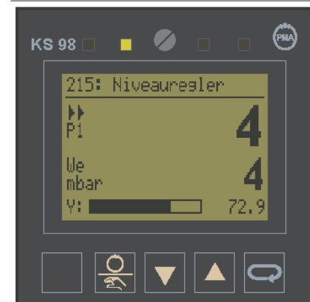
Verbrauchs im Verlauf der letzten 24 Stunden, eine Übersicht über den aktuellen Tagesverbrauch und den der letzten 5 Tage sowie die Niveaureglerseite. Der Regler kann in der Parameterebene in den Handbetrieb geschaltet werden, um die Pumpen manuell anzusteuern. Eine weitere Seite zeigt eine Übersicht über die verbrauchten Mengen der letz-
