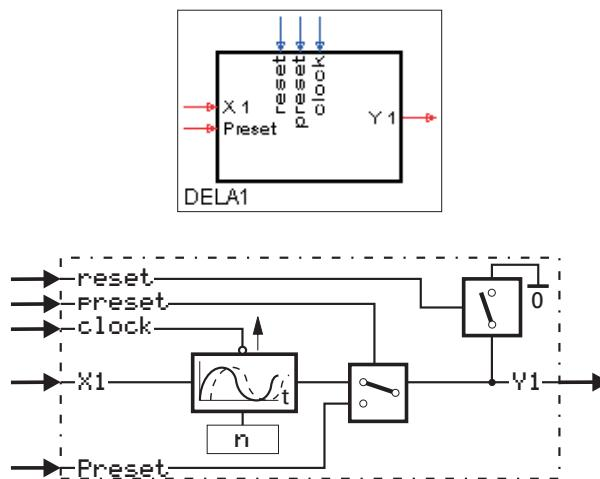
Bei nicht verdrahtetem clock-Eingang führt die Funktion die Berechnung  $y_1(t) = x_1(t - n \cdot ts)$  durch
