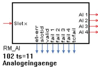
Die Funktion **RM\_AI** bearbeitet die Daten von angeschlossenen analogen Eingangsmodulen.
