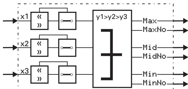
Die analogen Eingänge **x1**, **x2** und **x3** werden der Größe ihrer momentanen Werte nach geordnet und an den Ausgängen **Max**, **Mid** und **Min** ausgegeben. An **Max** wird der größte, an **Mid** der mittlere und an **Min** der kleinste Eingangswert ausgegeben.
