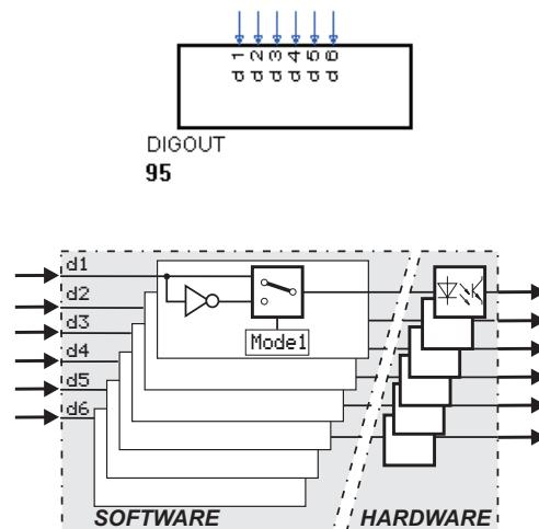
Die Funktion 'DIGOUT' dient zur Konfiguration und Parametrierung der digitalen Ausgänge. Sie belegt fest die Blocknummer 95 und wird fest alle 100 ms berechnet. Es kann eine Invertierung jedes einzelnen Signals konfiguriert werden. Das Vorhandensein aller digitalen Ausgänge ist abhängig von den Hardware-Optionen des KS98.
