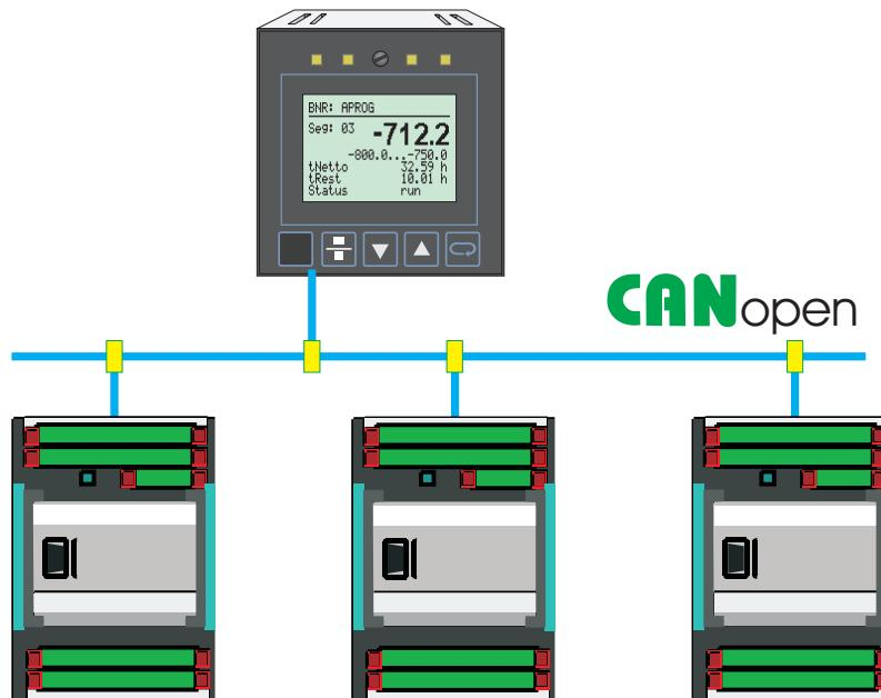
Mit den Funktionsblöcken C\_KS8x und KS8x kann über den CANopen Bus eine Verbindung zwischen der Multifunktionseinheit KS98+ und den Multi-Temperaturreglern KS 800 und KS 816 aufgenommen werden.
