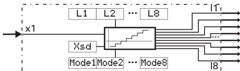
Die Funktion überprüft die Eingangsgröße  $x_1$  auf 8 Alarmwerte **L1** ... **L8**. Je nach Konfiguration durch **Mode 1** ... **Mode 8** wird der zugehörige Alarmwert als MAX- oder MIN-Alarm bewertet.
