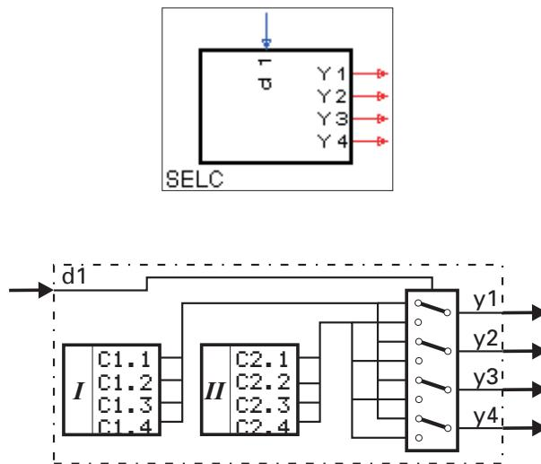
Abhängig von dem Steuersignal  $d1$  werden entweder die vier voreingestellten Parameter der Gruppe I oder der Gruppe II ausgegeben.
