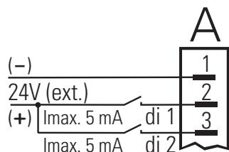
Digitale Ein- und Ausgänge an einer Spannungsquelle (z.B. Leiste B)
