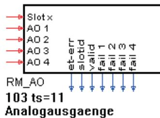
Die Funktion **RM\_AO** bearbeitet die Daten von angeschlossenen analogen Ausgangsmodulen.
