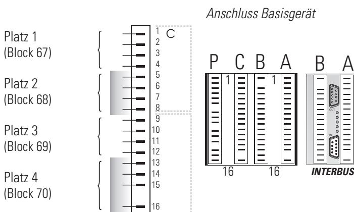
**29.****Modular I/O - E/A-Erweiterungsmodul****29.1****TC\_INP (analoge Eingangskarte TC, mV, mA)**
