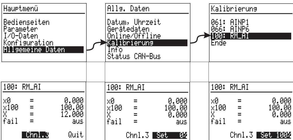
Zunächst wird der abzulegende Kanal angewählt. Mit der **▲**-Taste kann die Kanalnummer (**chnl.1**) angewählt und nach Bestätigen durch die **■**-Taste auch verändert werden.
