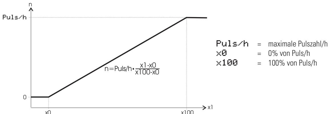
Die Impulslänge entspricht der für diesen Block eingestellten Abtastperiode (100, 200, 400 oder 800ms). Die Länge der Ausschaltzeit zwischen den Impulsen ist nicht immer gleich lang und abhängig von der konfigurierten Abtastperiode. Die Abtastzeitzuordnung bestimmt auch die maximale Anzahl von Impulsen/Stunde, die realisierbar sind. Werden in dem Parameter Puls/h größere Werte eingetragen, als aufgrund der Abtastzeit ausgegeben werden können, wird auf die maximal mögliche Impulszahl begrenzt.
