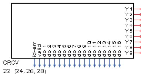
Die Funktion CRCV kann Daten von einem anderen KS98+ empfangen. Die Daten der anderen Multifunktionseinheit werden mit der CSEND Funktion bereitgestellt. Hierbei ist die Blocknummer des CSEND um 1 kleiner als die CRCV Blocknummer.
