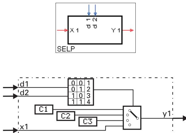
Abhängig von den Steuersignalen d1 und d2 wird entweder einer der drei voreingestellten Parameter C1, C2, C3 oder die Eingangsgröße x1 mit dem Ausgang y1 verbunden.
