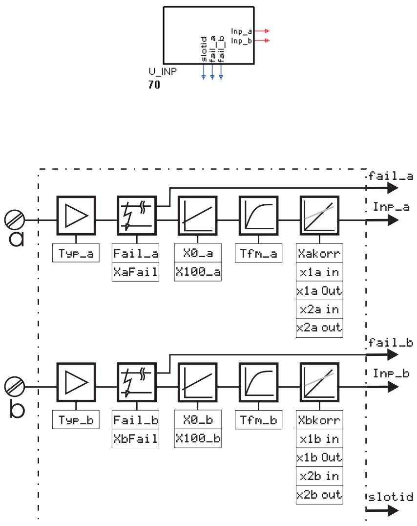
Zur Konfigurierung und Parametrierung des analogen Einganges **U\_INP**.
