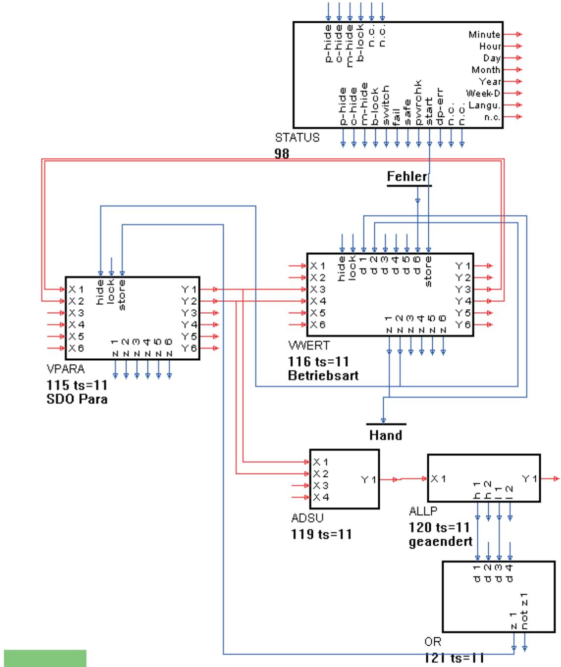
Dieses Teilengineering zeigt die Möglichkeit, auf Parameter des SDO-Blockes über eine Bedienseite zuzugreifen.
