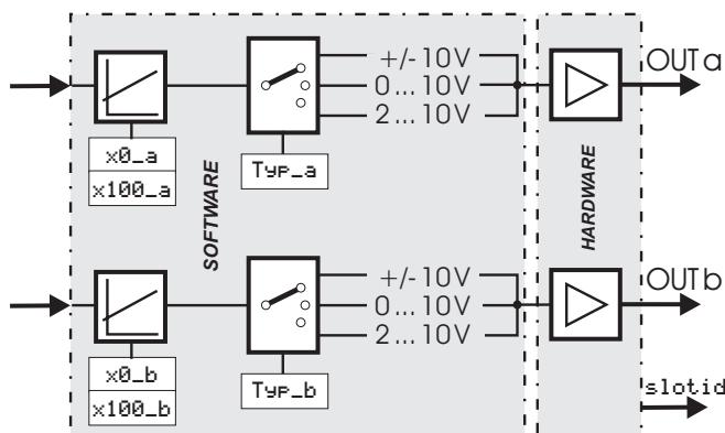
Zur Konfiguration und Parametrierung des analogen Ausganges **U\_OUT**.
