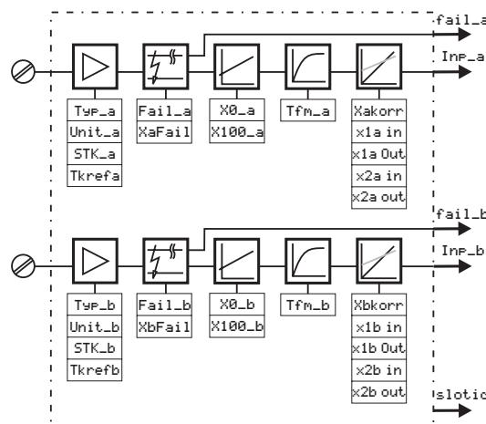
Zur Konfigurierung und Parametrierung der analogen Eingänge **TC\_INP**.
