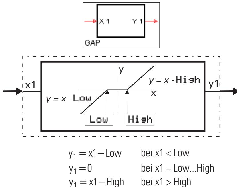
Der Bereich der Totzone wird mit den Parametern **Low** (untere Grenze) und **High** (obere Grenze) eingestellt. Befindet sich der Eingangswert  $x_1$  innerhalb der Totzone ( $\text{Low} \leq x_1 \leq \text{High}$ ), so ist der Ausgangswert  $y_1 = 0$ . Wird  $x_1$  nicht benutzt, wird dies als  $x_1=0$  interpretiert
