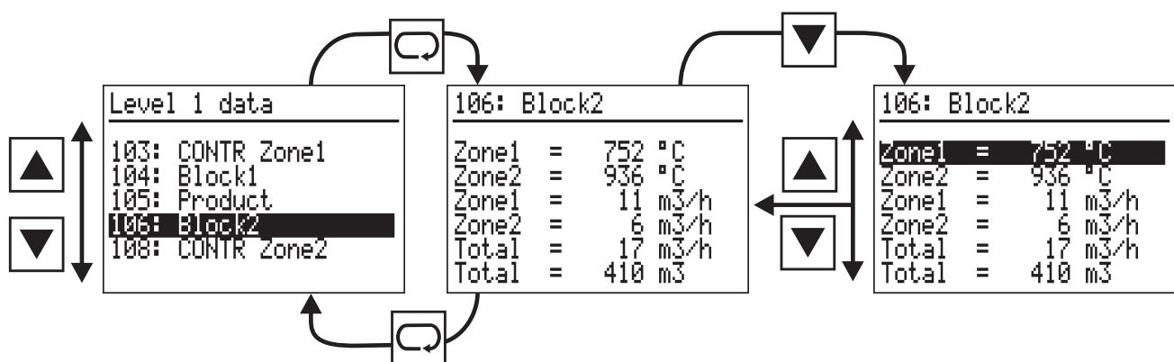
Wird die Taste für > 3 s gedrückt, so wird ein *Anwendermenü* gezeigt, das je nach Geräteausführung unterschiedlich ist (Standard / Echtzeituhr / Status / Status CANbus / Mod-C Status usw.):
