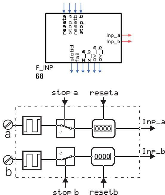
Zur Konfigurierung und Parametrierung des Einganges **F\_INP**.
