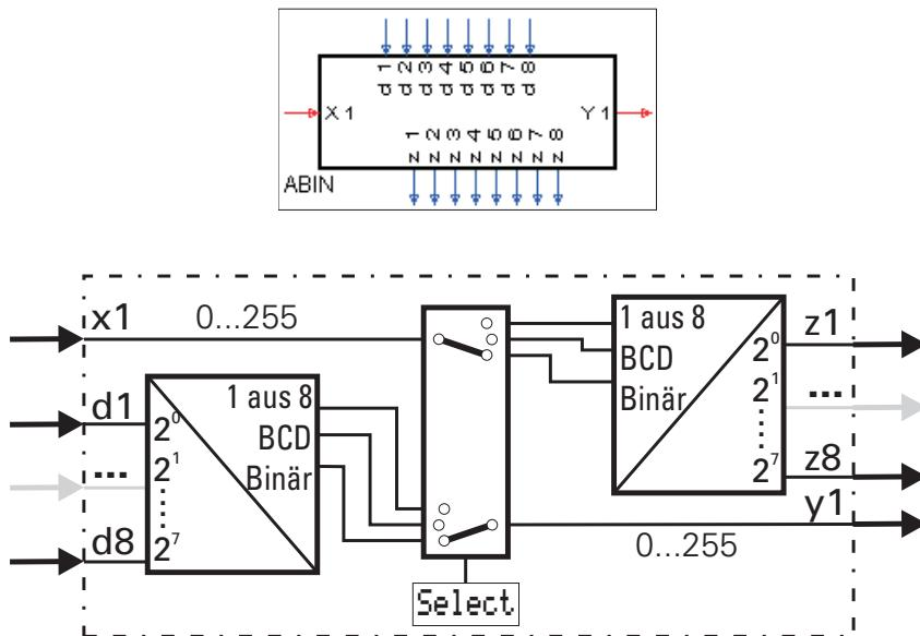
Die analoge Eingangsgröße  $x_1$  wird in eine binäre Zahl, eine BCD-Zahl oder eine Selektion "1 aus 8" gewandelt. Dabei wird  $x_1$  immer gerundet (Werte  $< 0,5$  abgerundet, Werte  $\geq 0,5$  aufgerundet).
