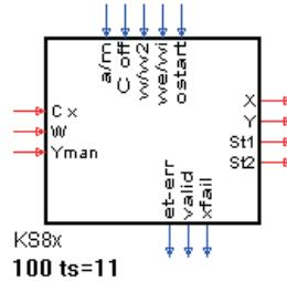
Die **KS8x** - Funktionen bearbeiten jeweils einen Regler aus dem KS 800 bzw. KS 816. Mit den analogen und digitalen Eingängen können die Signale für die Regelung zum Regler im KS800/16 gesendet werden. Die analogen Ausgänge liefern die Prozess- und Reglerwerte.
