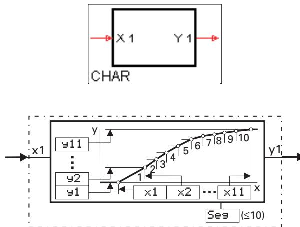
Mit bis zu 11 einstellbaren Stützpunkten können nichtlineare Funktionen nachgebildet oder linearisiert werden. Jeder Stützpunkt besteht aus dem Eingang  $x(1)$  und dem Ausgang  $y(1)$ . Die Anzahl der Wertepaare wird mit dem Konfigurationsparameter  $Sse$  bestimmt (Anzahl der Segmente +1 entspricht der Anzahl der Wertepaare).
