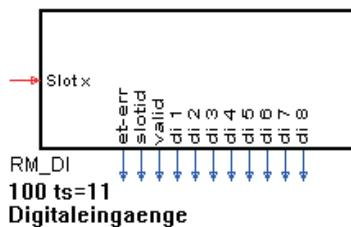
Die Funktion **RM\_DI** bearbeitet die Daten von angeschlossenen digitalen Eingangsmodulen.
