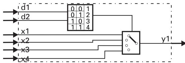
Abhängig von den Steuersignalen d1 und d2 wird einer der vier Eingänge x1...x4 mit dem Ausgang y1 verbunden.
