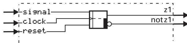
Der digitale Signalzustand am statischen Eingang **signal** wird an den Ausgang **z1** weitergegeben, wenn am Takteingang **clock** ein Signalwechsel von 0 auf 1 erfolgt (positive Flanke), und der Eingang **reset** auf logisch 0 liegt.
