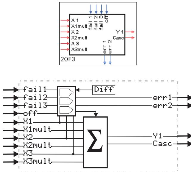
Die Funktion 2OF3 bildet den arithmetischen Mittelwert aus den Eingangsgrößen  $x_1$ ,  $x_2$  und  $x_3$ . Es wird der Betrag der Differenzen von  $x_1$ ,  $x_2$  und  $x_3$  gebildet und mit dem Parameter **Diff** verglichen. Eingänge, deren Wert diesen Grenzwert überschreiten, werden bei der Mittelwertbildung nicht verwendet.
