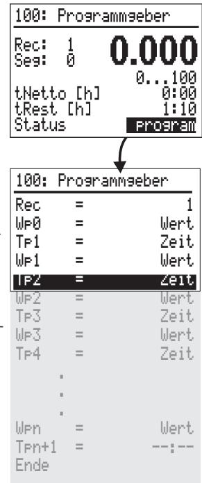
In der Statuszeile kann dann der Menüpunkt **Programm** angewählt werden. Nach Bestätigen können alle zu einem wirksamen Rezept **Rec** gehörenden Segmentparameter **TP** und **WP** in einem Scroll-Fenster angezeigt und eingestellt werden (Fig. 7). **Ende** führt wieder zur normalen Bedienung zurück.
