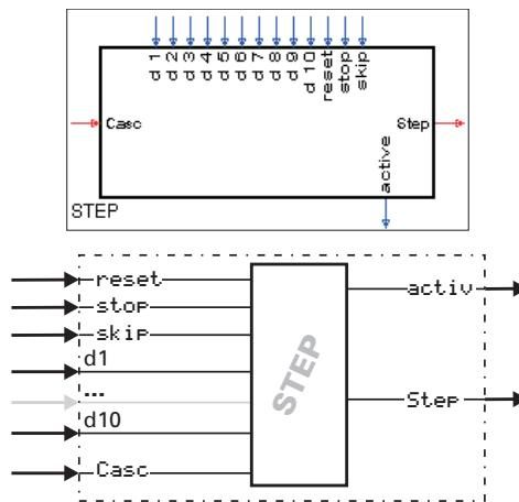
Die STEP-Funktion führt die einzelnen Schritte für eine Ablaufsteuerung durch.
