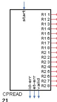
Die Funktion CPREAD dient dem Lesezugriff auf Geräte-PDOs. Wegen des üblichen Umfangs von mindestens 2 PDO's pro Gerät wurde der Datenumfang von 2 PDO's mit 2 COB-ID's in einem Block zusammengefaßt.
