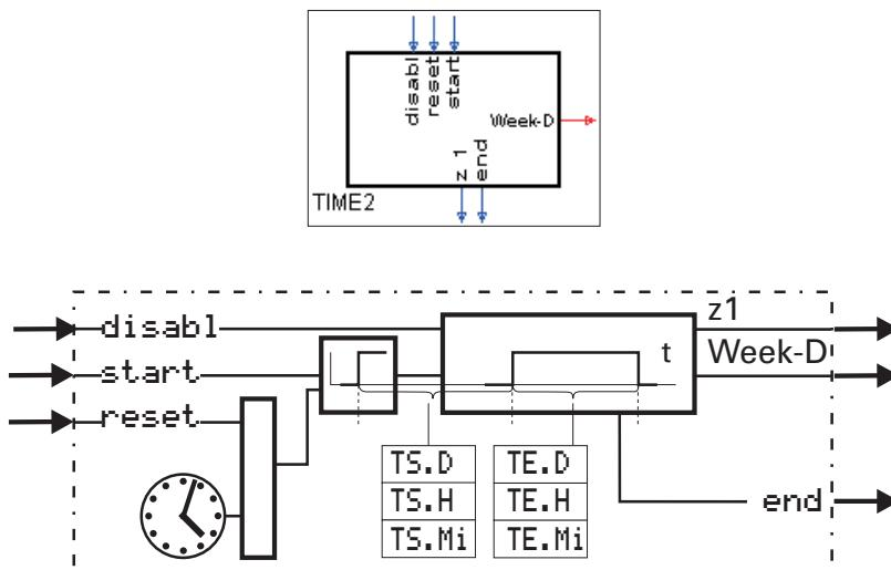
Die Funktion TIME2 kann nur bei Geräten mit Echtzeituhr verwendet werden (9407-9xx-2xxx). Mit einer positiven Flanke an **start** wird der TIME2 gestartet und nach Ablauf der Zeit **TS** der Ausgang **z1** auf 1 geschaltet, der nach Ablauf der Zeit **TE** wieder auf 0 gesetzt wird.
