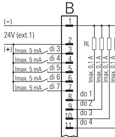
Digitale Ein- und Ausgänge an zwei Spannungsquellen (z.B. Leiste B)
