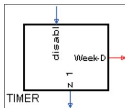
Die Funktion TIMER kann nur bei Geräten mit Echtzeituhr verwendet werden. Der Ausgang  $z_1$  wird zum absoluten Zeit-
