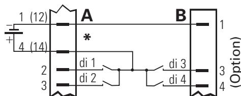
\* Wird A14/A12 für di1/di2 verwendet, muß A12 mit A1 verbunden werden
