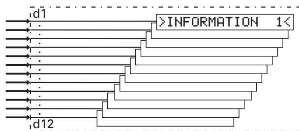
Mit dieser Funktion können 12 Anwendertexte mit je maximal 16 Zeichen durch Setzen des entsprechenden Einganges **d1...d12** angezeigt werden. Die Information erscheint auf den Bedienseiten in der "Kopfzeile" im Wechsel mit der Bezeichnung der aufgerufenen Bedienseite. Sollten mehrere Informationen gleichzeitig anliegen, werden sie der Reihe nach zyklisch eingeblendet.
