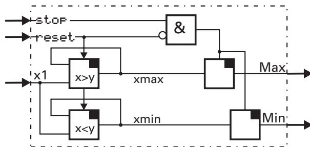
In jedem Abtastzyklus  $T_s$  werden der maximale Eingangswert  $x_{\max}$  und der minimale Eingangswert  $x_{\min}$  ermittelt, gespeichert und an den Ausgängen Max und Min ausgegeben. Wird der stop - Eingang auf 1 gesetzt, bleiben die zuletzt ermittelten Extremwerte erhalten.
