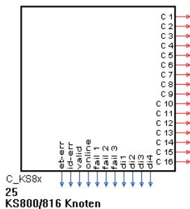
Die Knotenfunktion **C\_KS8x** stellt die Schnittstelle zu einem der Multi-Temperaturreglern KS 800 bzw. KS 816 her. An die analogen Ausgänge **C1 ... C16** können die **KS8x** - Funktionen, die jeweils einen Regler des KS 800 (bis zu 8 Regler) bzw. KS 816 (bis zu 16 Regler) darstellen, angebunden werden.
