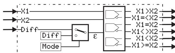
Die Funktion überprüft die beiden analogen Eingangswerte  $x_1$  und  $x_2$  auf Gleichheit.
