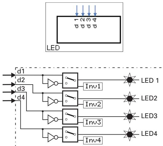
Mit der Funktion LED werden die 4 Leuchtdioden in der Gerätefront angesteuert. Die Funktion liegt fest auf der Blocknummer 96 und wird alle 100 ms berechnet. Die Zustände der digitalen Eingänge **d1...d4** werden auf die **LED 1...4** ausgegeben. Die Zustände können per Parameter **Inv** invertiert werden.
