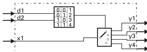
Abhängig von den Steuersignalen d1 und d2 wird die Eingangsgröße x1 an einem der Ausgänge y1, y2, y3 oder y4 verbunden.
