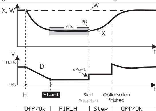
Nach einem erfolgreichen Adoptionsversuch geht der Regler in den Automatikbetrieb und regelt den Sollwert mit den neu ermittelten Parametern. Der Parameter **Ores** gibt an mit welchem Ergebnis die Selbstoptimierung abgeschlossen wurde (→ siehe Seite 188).
