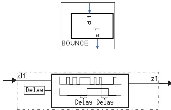
Diese Funktion dient zum Entprellen eines logischen Signals. Die Änderung des Eingangssignals **d1** wird erst dann an den Ausgang **z1** übertragen, wenn sie über die mit dem Parameter **Delay** eingestellte Zeit konstant geblieben ist. Die Genauigkeit der Zeitüberwachung ist abhängig von der Abtastzeit, der die Funktion zugewiesen wird.
