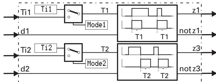
Die Funktion erzeugt am Ausgang  $z_1$  einen positiven Impuls der Länge  $T_{i_1}$ , wenn am Triggereingang  $d_1$  eine positive Flanke erkannt wird. Sie erzeugt am Ausgang  $z_3$  einen positiven Impuls der Länge  $T_{i_2}$ , wenn am Triggereingang  $d_2$  eine negative Flanke erkannt wird.
