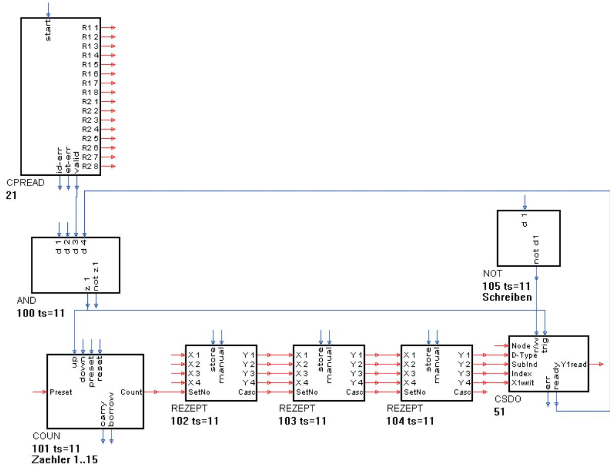
Das Beispiel-Engineering SDO-SEQ.EDG zeigt die Erzeugung einer endlosen SDO-Befehlssequenz. In den Rezeptblöcken sind die entsprechenden Werte für D-Typ, Subindex, Index und Wert gespeichert. Der Zähler ( COUN ) zählt kontinuierlich von 1 bis 15.
