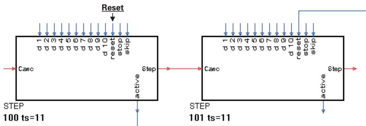
Um die Gesamtablaufsteuerung zurückzusetzen, wird der Reset am 1. Funktionsblock verdrahtet
