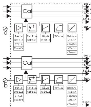
Zur Konfigurierung und Parametrierung der analogen Eingänge **R\_INP**.
