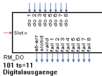
Die Funktion **RM\_DO** bearbeitet die Daten von angeschlossenen digitalen Ausgangsmodulen.
