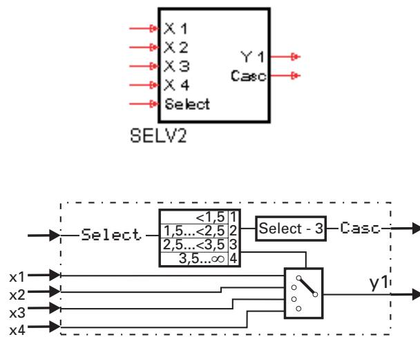
Abhängig vom Eingang Select wird einer der vier Eingänge x1...x4 mit dem Ausgang y1 verbunden.
