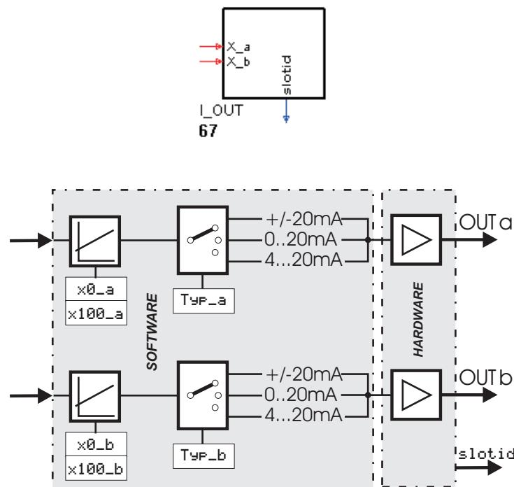
Zur Konfiguration und Parametrierung des analogen Ausgangs **I\_OUT**.
