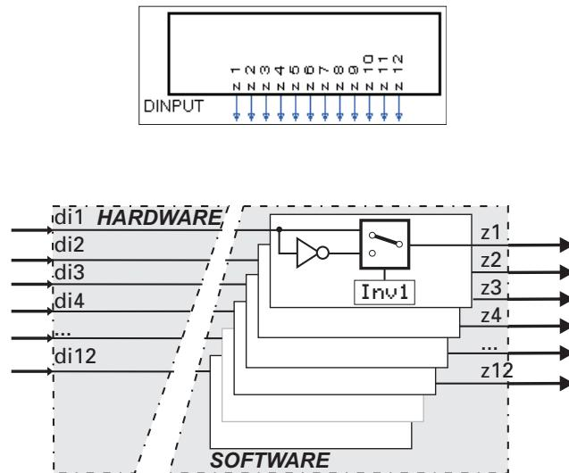
Die Funktion 'DINPUT' dient zur Konfiguration und Parametrierung der digitalen Eingänge. Sie belegt fest die Blocknummer 91 und wird alle 100 ms berechnet. Es kann eine Invertierung jedes einzelnen Signals konfiguriert werden. Das Vorhandensein der Eingänge di1...di12 ist abhängig von den Hardware-Optionen des KS98.
