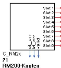
Das Koppelmodul RM201 enthält die Schnittstelle zum CAN-Bus und belegt den ersten Steckplatz.
