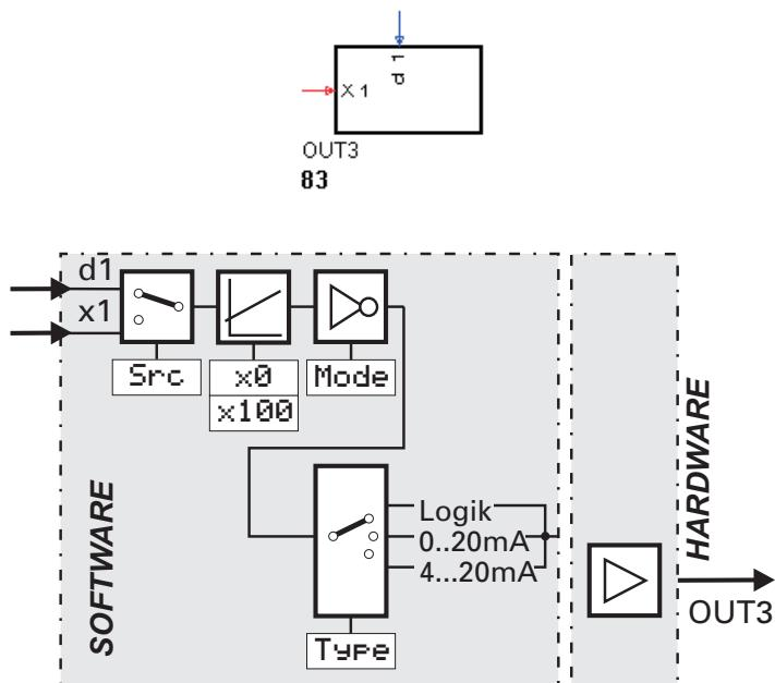
Die Funktion OUT3 dient zur Konfigurierung und Parametrierung des Prozessausgangs OUT3.
