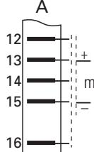
**Eingang Spannungssignale 0/2...10V**Der Eingangswiderstand beträgt  $\geq 100 \text{ k}\Omega$
