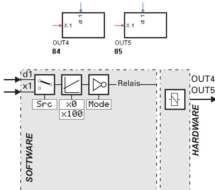
Die Funktionen OUT4 und OUT5 dienen zur Konfiguration und Parametrierung der Prozessausgänge OUT4 und OUT5.
