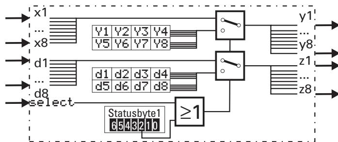
Die Funktion SAFE dient zur Erzeugung von vordefinierten analogen Ausgangswerten und digitalen Zuständen in Abhängigkeit vom digitalen Eingang select bzw. vom über die Schnittstelle empfangenen Status. Im Normalfall select = 0 und Status = 0 werden die an den Eingängen anliegenden Werte unverändert auf die Ausgänge durchgeschaltet. Für select = 1 oder Status = 1 werden die konfigurierten Daten **z1 ... z8** und **y1 ... y8** auf die Ausgänge durchgeschaltet.
