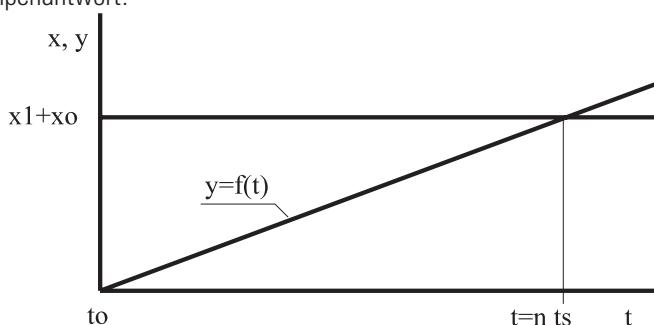
Die Funktion hat ein 'Gedächtnis'. Das heißt: nach Power-On arbeitet sie mit den Werten von  $y1$ ,  $z1$  und  $z2$  die vor dem Spannungsausfall bestanden weiter, sofern die RAM-Daten dann noch erhalten sind.
