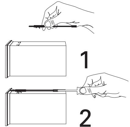
Das Gerät ist mit mindestens 2 Befestigungselementen zu befestigen (diagonal oben und unten).
