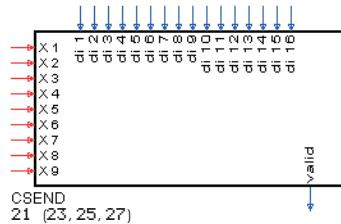
Die Funktion CSEND stellt Daten für andere KS98+ auf dem CANopen Bus zur Verfügung. Die Daten können von den anderen Multifunktionseinheit mit der CRCV Funktion gelesen werden.
