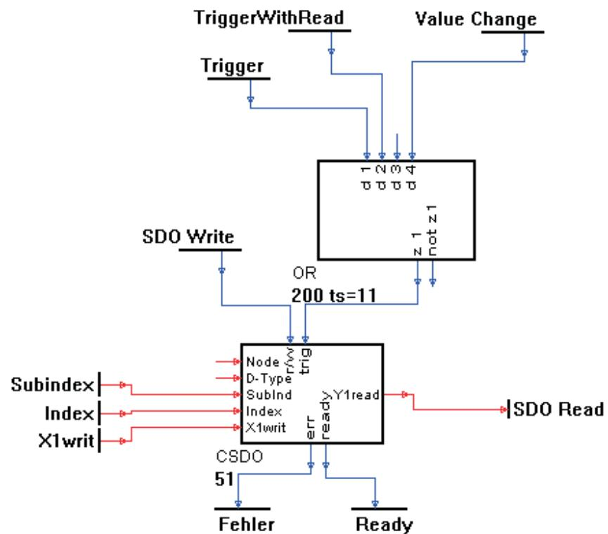
Die Befehlstriggerung erfolgt unter verschiedenen Bedingungen: beim Lesen, im Handbetrieb nach Änderung und zyklisch in Automatik.
