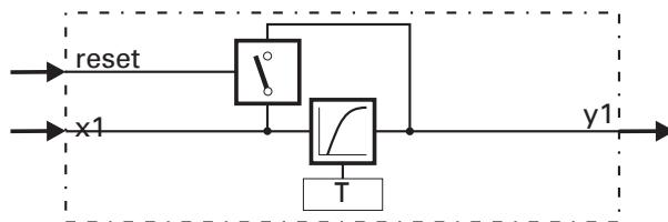
Abhängig von dem Steuereingang **reset** wird die Eingangsgröße **x1** verzögert (**reset** = 0) oder unverzögert (**reset** = 1) an den Ausgang **y1** weitergegeben. Die Verzögerung erfolgt nach einer e-Funktion 1. Ordnung (Tiefpaß 1. Ordnung) mit der Zeitkonstanten **T**. Die Ausgangsgöße für **reset** = 0 wird nach folgender Gleichung berechnet:
