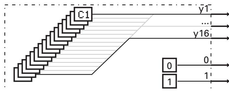
Es werden 16 analoge Konstanten am Ausgang  $y1 \dots y16$  und die logischen Zustände 0 und 1 zur Verfügung gestellt. Die Blocknummer ist mit 99 fest konfiguriert.
