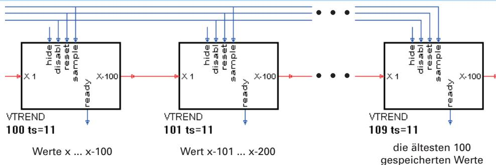
Durch Kaskadieren von VTREND Funktionsblöcken kann eine Trend- bzw. Datenaufzeichnung mit beliebig vielen Werten realisiert werden.
