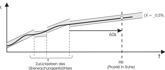
Mit dem Konfigurationswort **OCond** kann der Modus der 'Prozess in Ruhe'- Erkennung festgelegt werden. Es kann einer der folgenden Modi ausgewählt werden:
