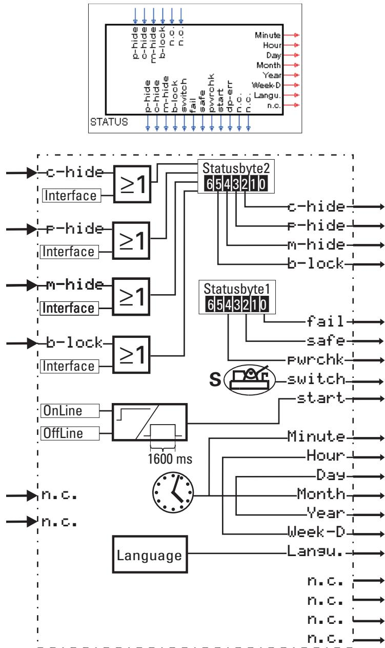
Die Funktion stellt an ihren digitalen Ausgängen Informationen aus dem KS98 Gerätetestatusbyte zur Verfügung. Die Blocknummer ist fest 98 und wird alle 100 ms aktualisiert.
