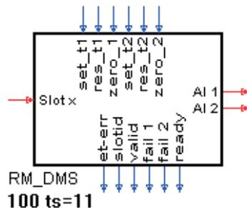
Die Funktion RM\_DMS liest Daten von einem speziellen Dehnungsmeßstreifen-Modul der KS98+ E/A-Erweiterung mit CANopen. An den Modul können maximal 2 Dehnungsmeßstreifen angeschlossen werden. Die Meßwerte stehen an den Ausgängen AI 1 und AI 2 zur Verfügung.
