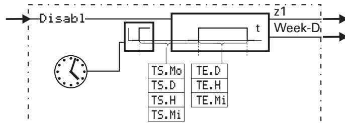
punkt  $TS$  eingeschaltet und  $TE$  später wieder ausgeschaltet. Dieser Schaltvorgang kann einmalig oder zyklisch erfolgen (Parametereinstellung). Der Ausgang **Week-D** zeigt den aktuellen Wochentag (0...6 = So...Sa).  $TS \text{ Mo} = 0$  und  $TS \text{.D} = 0$  bedeutet aktueller Tag.
