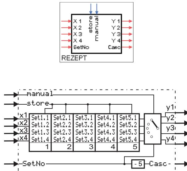
Die Funktion Rezept hat 5 Gruppen (Rezeptblöcke) zu je 4 Speicherplätzen. Die Rezepte können sowohl über die Parameterinstellung als auch über die analogen Eingänge beschrieben werden. Die Parameter der Funktion werden im EEPROM netzausfallsicher abgelegt.
