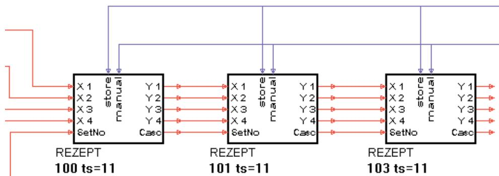
Bei Kaskadierung liegen die Werte für das gesamte Rezept an den Ausgängen y1...y4 der letzten Stufe an.
