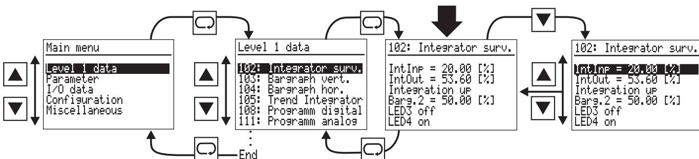
Die **▲** / **▼**-Tasten scrollen die markierte Zeile nach oben bis zum Anfang oder nach unten bis zum Ende des Menüs. Beim erneuten Drücken der Taste springt die markierte Zeile vom Anfang zum Ende oder umgekehrt.
