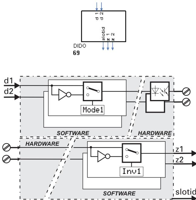
Zur Konfigurierung und Parametrierung der digitalen Ein-/Ausgänge **DIDO**. Der Funktionsblock wird fest einmal pro Zeitscheibe berechnet.
