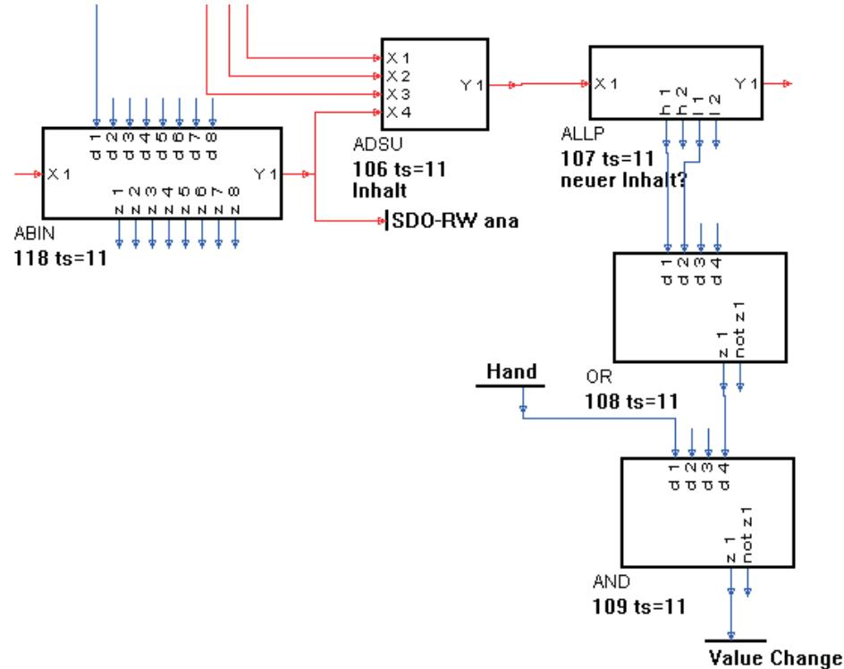
Diese Teilstufe überwacht die Änderung der Einstellwerte auf der Bedienseite und löst zur Speicherung in den Registerblöcken einen Puls (Value Change) aus.
