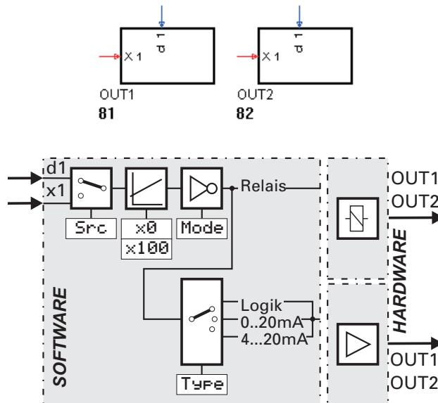
Die Funktionen OUT1 und OUT2 dienen zur Konfiguration und Parametrierung der Prozessausgänge OUT1 und OUT2. Bei den Ausgängen kann es sich je nach Hardware um Analog - oder Relais- Ausgänge handeln.
