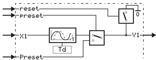
Die Funktion führt die Berechnung  $y1_{(t)} = x1_{(t-Td)}$  durch. Die Eingangsgröße **x1** wird um die Zeit  $Td$  verzögert an **y1** ausgegeben. Die Genauigkeit von  $Td$  ist abhängig von der Abtastzeit  $ts$ , der die Funktion zugewiesen wird.
