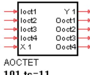
Die Funktion AOCTET wandelt einen Analogwert (X1) in die einzelnen Bytes (Oct1-4) eines Datentyps um, wie sie beispielsweise zur Übertragung über den CAN-Bus (siehe CPREAD / CPWRT) verwendet werden. In der CAN-Notation werden die Bytes im Intel-Format übertragen. Sollte diese von angeschlossenen Geräten nicht eingehalten werden müssen die Bytes eventuell wort- und byteweise vertauscht werden.
