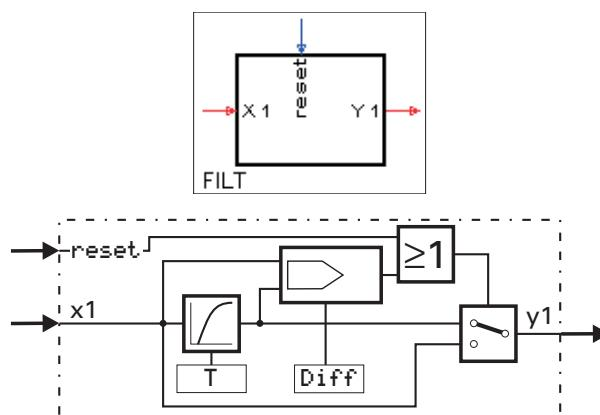
Der Filter erster Ordnung hat innerhalb eines Toleranzbandes um den letzten Ausgangswert ( $|x1 - y1| \leq \text{Diff}$ ) die komplexe Übertragungsfunktion  $F(p) = \frac{1}{1 + p \cdot T}$
