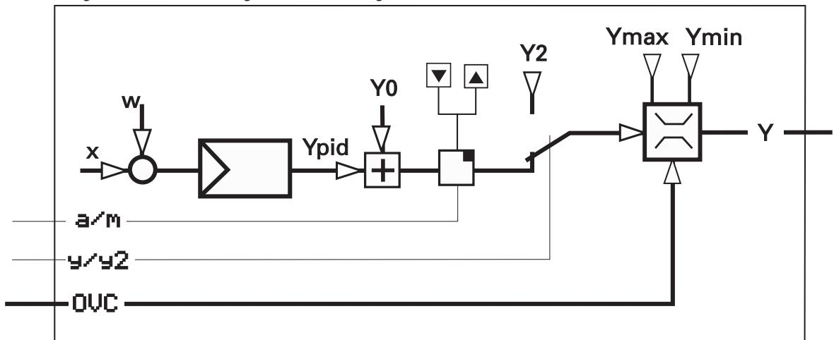
Sowohl bei der Stellwertverstellung von der Front aus  $\Delta$  als auch über die Steuereingänge "inc" und "dec" wird der aktuelle Stellwert im Handbetrieb in 0,1% Schritten inkrementiert bzw. dekrementiert. Die Verstellgeschwindigkeit beträgt eine Sekunde pro 1%.
