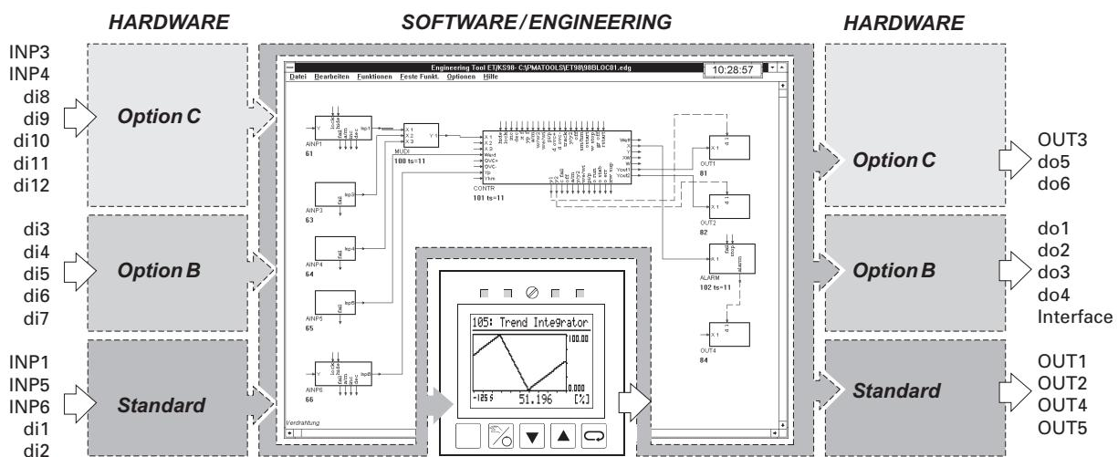
Die zusätzliche Modulare OptionC CANopen-Schnittstelle ergänzt die Multifunktionseinheit KS 98+ bereits im Grundgerät um
