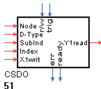
Die Funktion CSDO erlaubt den Zugriff auf den CAN-Bus mittels SDO's (Service Data Objects). SDO's werden für den asynchronen Datenaustausch ohne Echtzeitanforderung verwendet.
