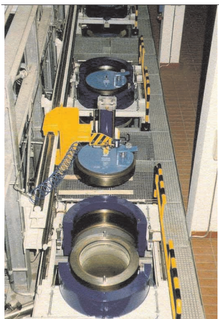
Bild 2: "Produktionsanlage mit 3 Extraktoren je 500 Liter und über 400 bar Extraktionsdruck zur Extraktion von Gewürzen"
